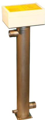
Цилиндрическая часть из полированной нерж. стали V4A (1.4571), обработанная снаружи дробеструйной установкой, подключение 2 x 2" AG, дренажное отверстие ½" IG, макс. рабочее давление 2,5 бар. Срок службы УФ-ламп прибл. 7000 - 8000 часов работы. Блок управления с индикатором режима и контролем времени работы.
